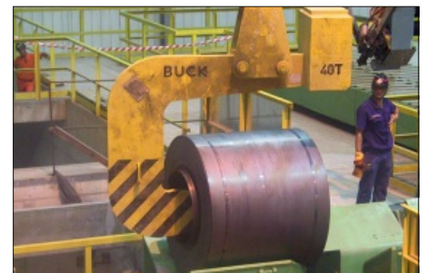
As bobinas a quente produzidas pela CST têm características variadas, com espessura de 1.2 a 16 mm
